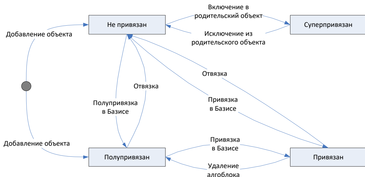
Рисунок 8 - Состояния объектов при их привязке
