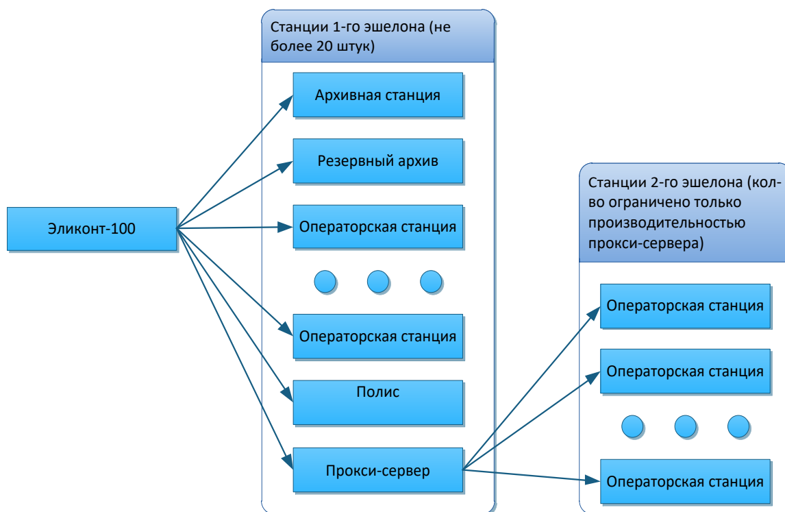
Рисунок 3 – Разделение Операторских станций на 2 эшелона
